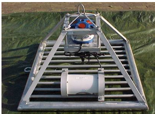
Figuur 3 ADCP geplaatst in meetframe
